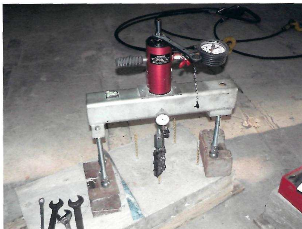
Рис.2. Домкратная установка в момент испытания стеклопластикового арматурного выпуска на вырыв из монолитного бетона.
